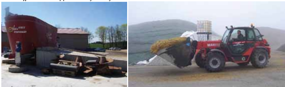
Σχήμα 7.10: Σύστημα κιβωτίων τροφοδοσίας για ξηρή πρώτη ύλη χορτονομή αραβοσίτου και στερεή κοπριά πουλερικών (αριστερά) και μηχάνημα φόρτωσης με χορτονομή αραβοσίτου (δεξιά) (RUTZ 2008)
