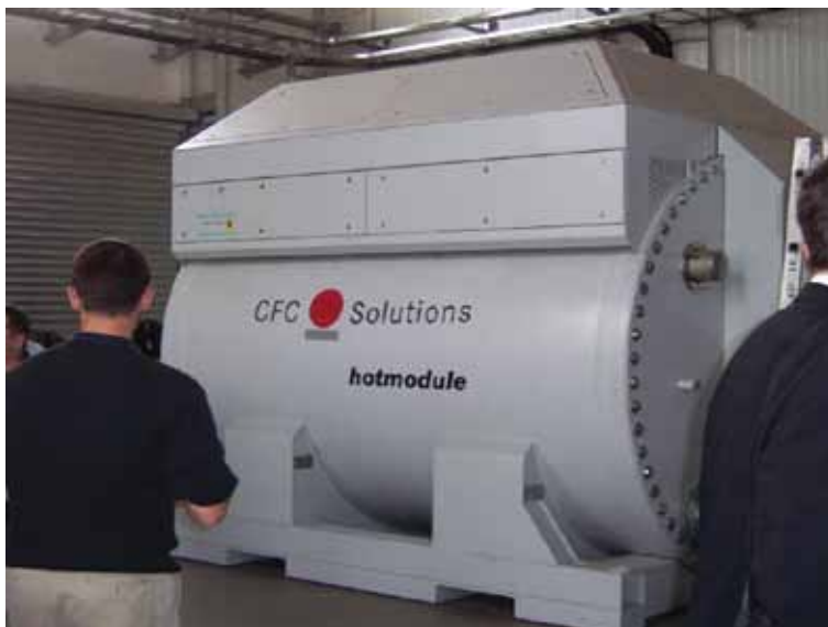
Σχήμα 5.6: Η πρώτη παγκοσμίως κυψέλη καυσίμου τύπου MCFC για βιοαέριο, που λειτουργεί στη Γερμανία (RUTZ 2007)
