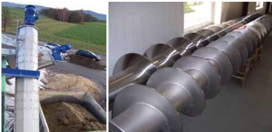
Σχήμα 7.12: Σύστημα μεταφοράς κοχλιωτής σωλήνας (αριστερά) και μεταφορικοί κοχλίες έτοιμοι για εγκατάσταση (δεξιά) (RUTZ 2007)
