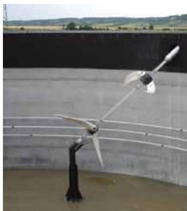
Σχήμα 7.23: Αναδευτήρες κρεμασμένων περυγίων (αριστερά) και η αντίστοιχη μηχανή ανάδευσης (δεξιά) (AGRINZ 2006)
