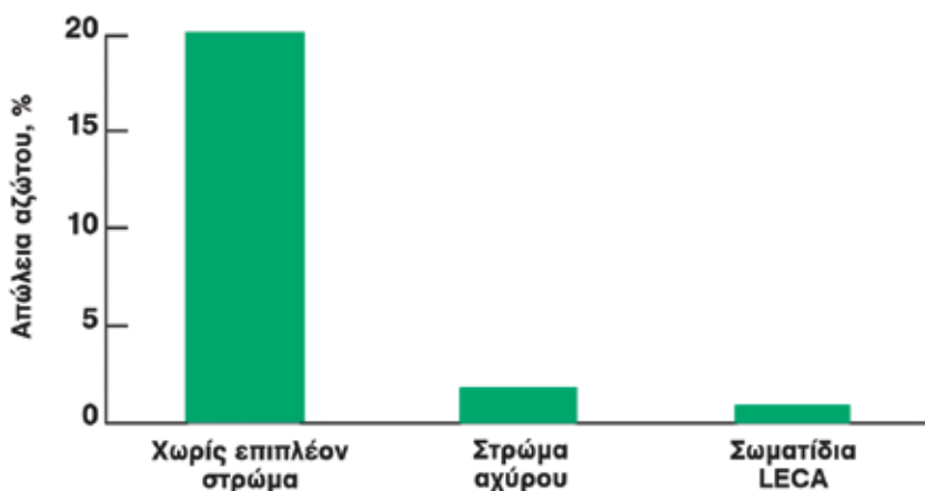
Σχήμα 7.35: Το επιπλέον κάλυμμα στις δεξαμενές αποθήκευσης του χωνεμένου υπολείμματος μειώνει την αεριοποίηση της αμμωνίας (BIRKMOSE 2002)
