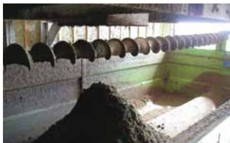
Σχήμα 6.5: Βαγόνι συλλογής των ινών, με κοχλία ως διανομέα (ANGELIDAKI 2004)
