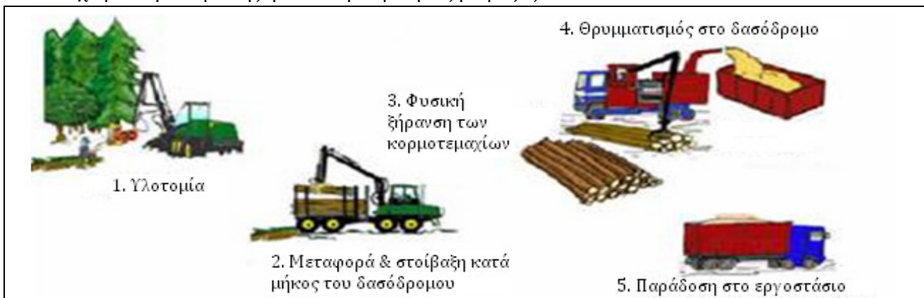
Σχήμα 4.7.3 Παραγωγή δασικού θρυμματισμένου ξύλου μετά τη φυσική ξήρανση της πρώτης ύλης είτε σε χώρο συγκέντρωσης ή σε κέντρο εμπορίας βιομάζας [13]
