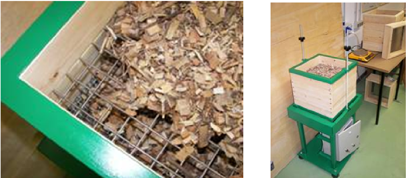
Εικόνα 4.3.1 Συσκευή για τον προσδιορισμό του μεγέθους των θρυμμάτων ξύλου (AIEL, 2006)
