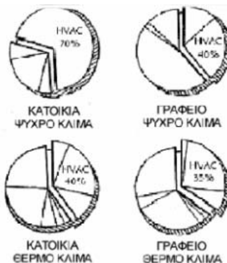
Σχήμα 2. Σχετικό ποσοστό της συνολικής ενεργειακής χρήσης ενός κτιρίου που αποδίδεται στη λειτουργία των συστημάτων HVAC για κατοικίες και χώρους γραφείων σε θερμά και κρύα κλίματα.
