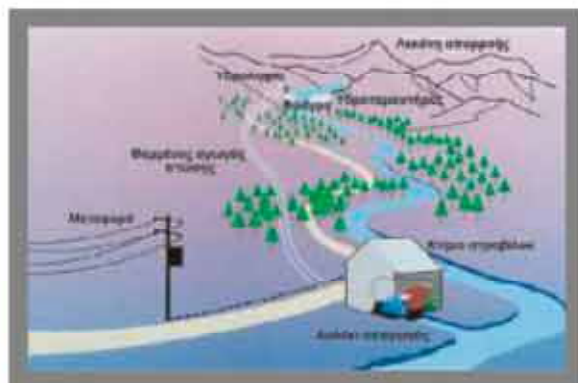
Σχήμα 6.2. Παράσταση ενός ΜΥΗ μεγάλου ύψους πτώσης
