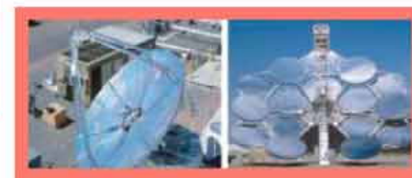
Σχήμα 4.10. Φωτογραφίες από συστήματα δίσκου/Stirling [Αριστερά: Δίσκος One Omnium G του SERI – Δεξιά: Κέντρο δοκιμών της Αριζόνας]
