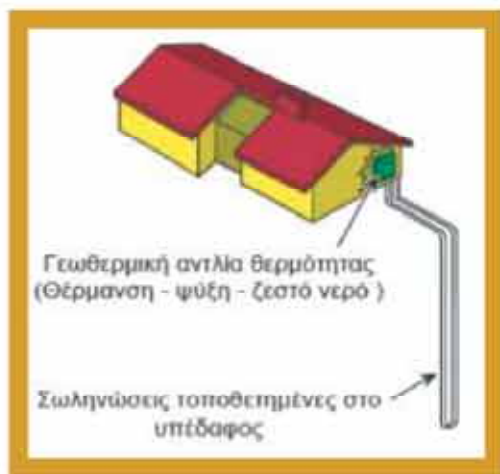
Σχήμα 3.6. Γήινα εναλλάκτες θερμότητας [Πηγή: University of Utah- Geothermal Brochure]
