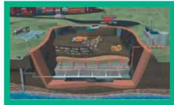
Σχήμα 2.7. Χώρος Υγειονομικής Ταφής Απορριμμάτων (ΧΥΤΑ)
